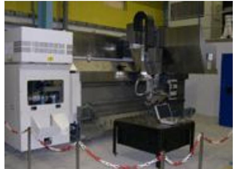
**Machine DMD de Trumpf (utilisée à
