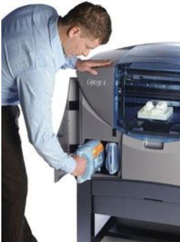
Exemple de rechargement de matériel par remplacement d'une cartouche.
