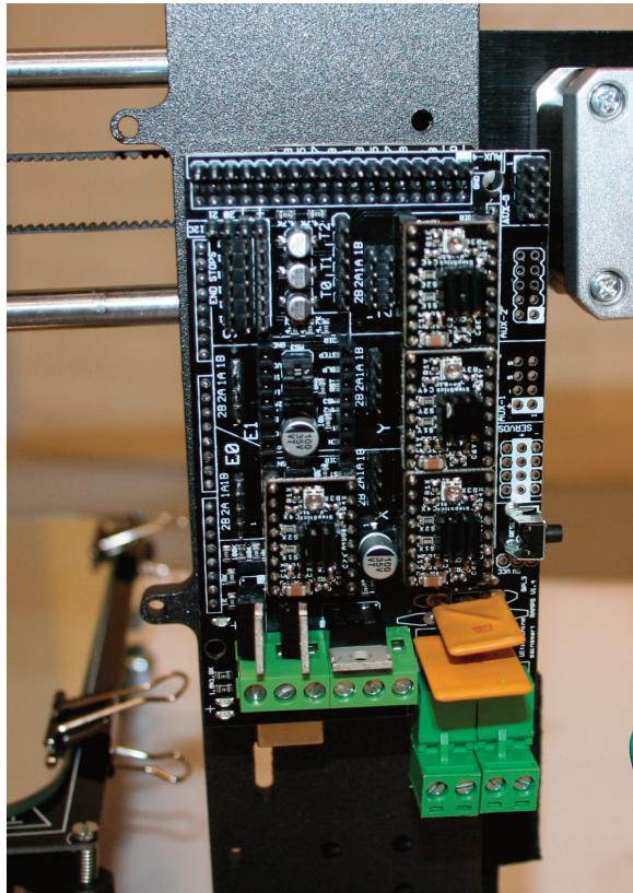
Brancher le connecteur du ventilateur sur la barrette 2 plots de la carte RAMPS une fois mise en place.
