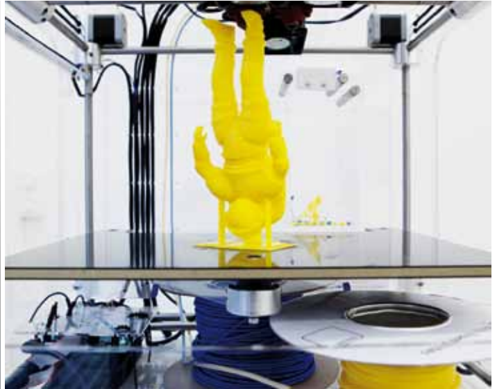
Image de gauche: objet d'art imprimé par une imprimante 3D industrielle. Image de droite: astronaute créé en plastique couche par couche grâce à une imprimante 3D.
