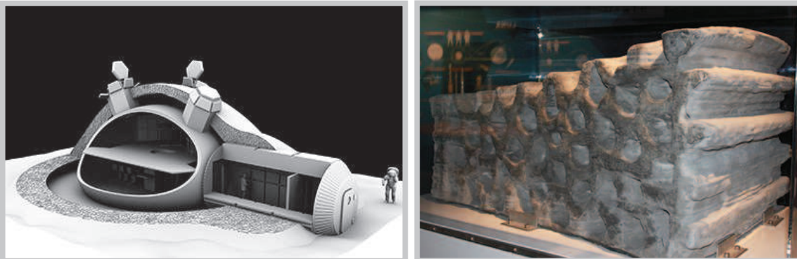
Plan des dômes lunaires prévus par l'Agence spatiale européenne (image de gauche) et coupe transversale des murs imprimés par Foster and Partners dans le cadre de ce projet (image de droite) (source : site officiel de l'Agence spatiale européenne)
