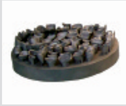
Fig 28. Exemple de production d'armatures en Co-Cr. Source : Phenix Systems.
