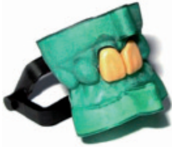
Fig 29. Modèle physique d'occlusion modelé par fabrication additive à partir d'une modélisation 3D. Source : 3Shape.
