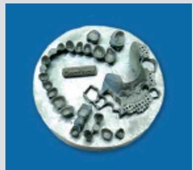
Fig 26. Fabrication directe de châssis de prothèse mobile par micro-fusion laser sur machine PM100 Dental de Phenix Systems. Source : Dentinov.
