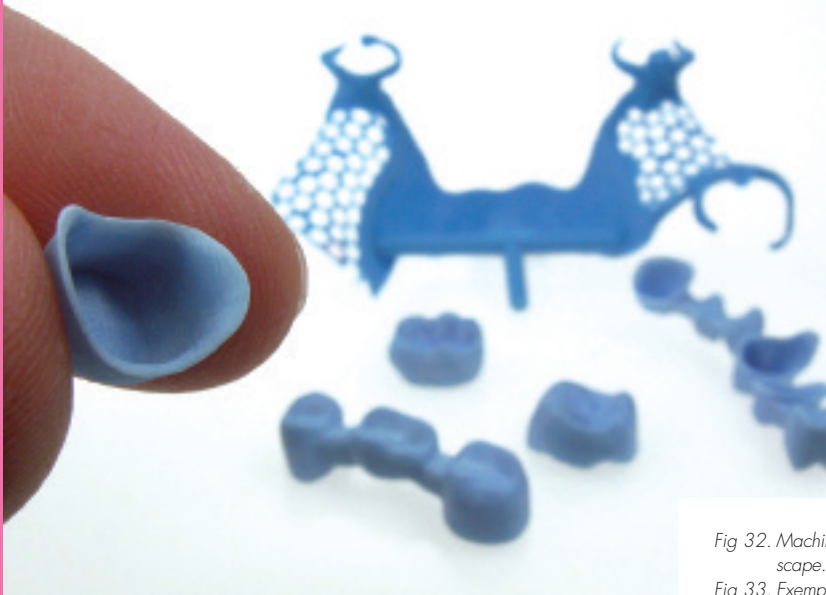
Fig 31. Exemple de production de modèles en cire.
