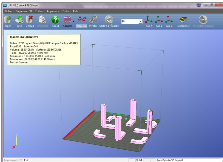
Une fois le modèle de calibrage imprimé, mesurez les longueurs X1 et X2, comme indiqué dans les images ci-dessous.
