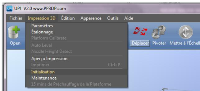
L'imprimante émet 4 bips et la procédure d'initialisation débute, les trois axes se mettent en mouvement pour prendre leurs origines. Elle émet à nouveau un bip lorsqu'elle est prête.
