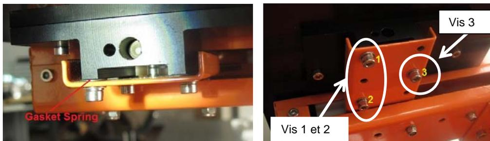
**Note** : en desserrant une vis, le coin correspondant s'élève. Serrez ou desserrez la vis jusqu'à ce que vous ayez le même espace entre la buse et le plateau, aux deux coins du plateau.
