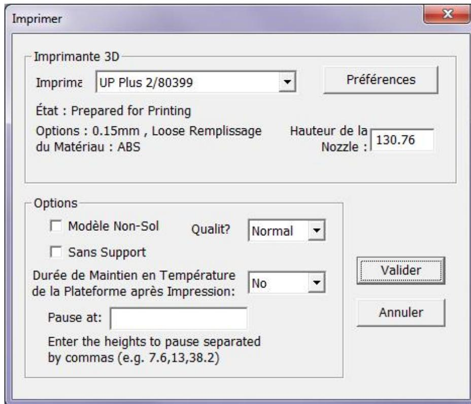
**Hauteur de la Nozzle** Position de la buse par rapport à l'origine de la plateforme.
