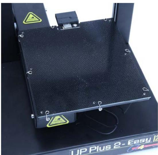
*L'imprimante est munie de petits crochets ressorts fixés à la plateforme qui facilitent la mise en place du plateau martyr.*
