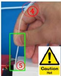
Insérez le fil dans le trou situé au sommet de la tête d'extrusion et maintenez-le avec une légère pression jusqu'à ce que le moteur de l'extrudeuse le saisisse et commence à le tirer à travers la tête d'extrusion.
