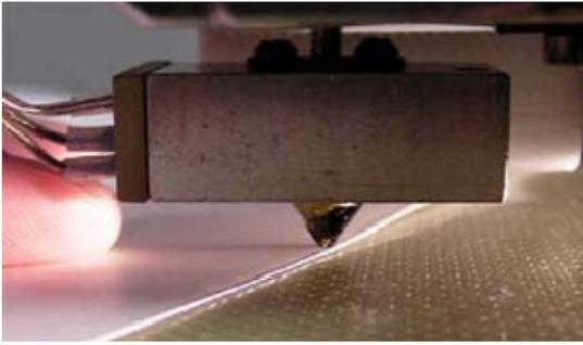
**Note** : un moyen facile de vérifier la distance entre la buse et le plateau est d'utiliser une feuille de papier (papier 80 g/m<sup>2</sup>) pliée ou non, ce qui représente une épaisseur entre 0,1 et 0,2 mm. La feuille ne sera jamais bloquée car la fixation de la tête d'impression est souple. On peut monter trop haut le plateau sans que la feuille ne se bloque. Il faut évaluer avec finesse le moment où le plateau commence à frotter sur la buse.
