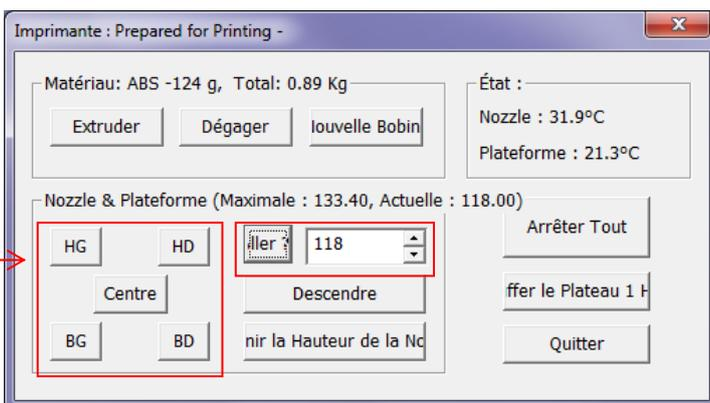
Pour déplacer la buse aux quatre coins du plateau, utilisez les 4 boutons **HG**, **HD**, **BG** et **BD**.
