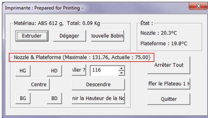
Vous retrouvez la valeur 130,76 mm à laquelle le système à ajouter 1 mm. Il s'agit d'une marge de sécurité. C'est la valeur maximale de déplacement manuel de la buse afin d'éviter tout risque de détérioration en cas de fausse manipulation.
