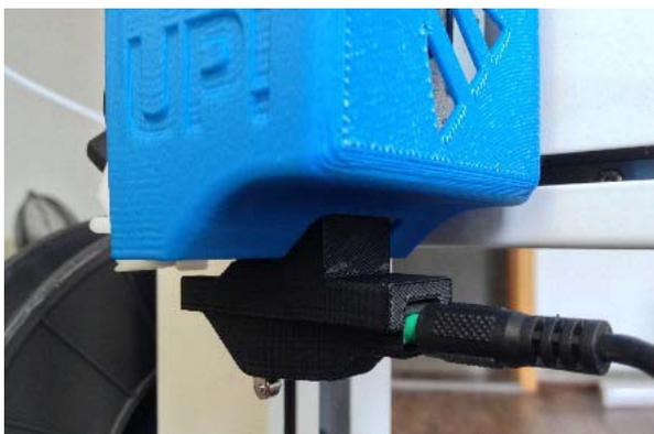
Vous devez le brancher à l'arrière de l'imprimante par le biais du câble jack 3,5 mm en veillant à ce que le fil passe bien par l'extérieur du cadre pour ne pas entraver le déplacement de la plateforme. Une fois installé, cliquez sur **Auto Level** à partir du menu **Impression 3D**.
