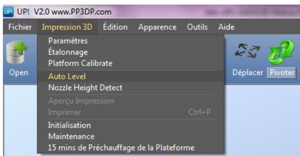
La plateforme monte alors tout doucement jusqu'au contact du capteur puis se déplace afin de prendre 9 points de mesures.
