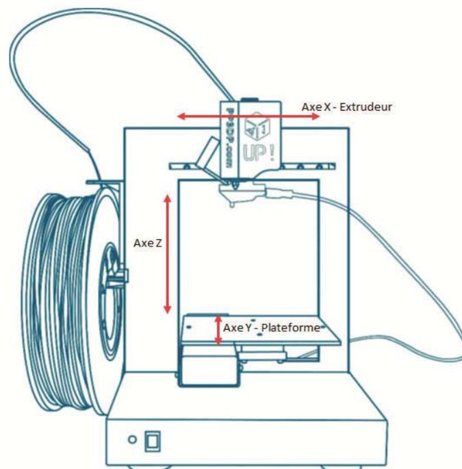
Le moteur de l'axe Z est muni de freins ce qui évite la chute brutale de l'axe en cas de coupure subite de courant.
