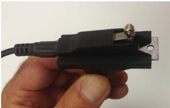
Il se place facilement par aimantation en dessous de la tête d'extrusion.
