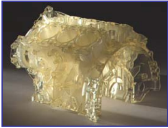
Fulcure720, imprimé sur Eden, couche de 16µ
