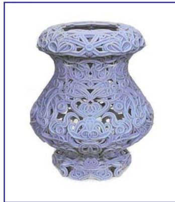
VeroBlue, imprimé sur Eden 500, couche de 30µ
