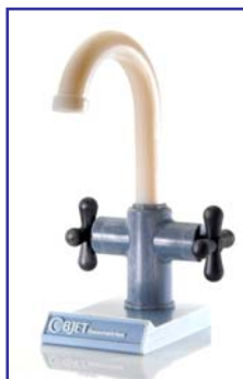
Pièces réalisées en bi matière en une seule fois sur une imprimante 3D de la gamme Connex
