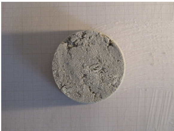
E/C = 0.7 ; Le mélange est très sableux, il ne s'écoule pas du tout ; présence de grumeau de ciment (semblable à E/C = 0,4, 0,5 et 0,6 ) Les grumeau sont cependant plus homogènes.
