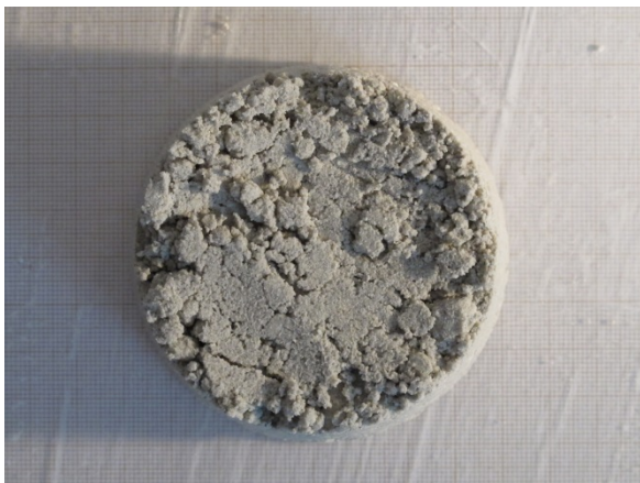
E/C = 0.6 ; Le mélange est très sableux, il ne s'écoule pas du tout ; présence de grumeau de ciment (semblable à E/C = 0,4 et 0,5 ) Les grumeau sont cependant plus homogènes.
