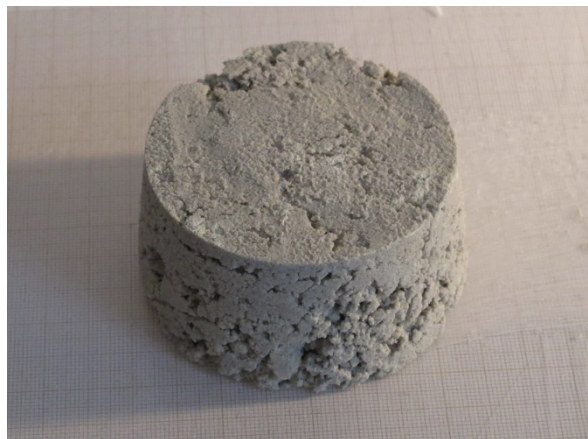
E/C = 0.7 ; Le mélange est très sableux, il ne s'écoule pas du tout ; présence de grumeau de ciment (semblable à E/C = 0,4, 0,5 et 0,6 ) Les grumeau sont cependant plus homogènes.
