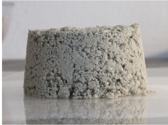
E/C = 0.5 ; Le mélange est très sableux, il ne s'écoule pas du tout ; présence de grumeau de ciment (semblable à E/C = 0,4 )
