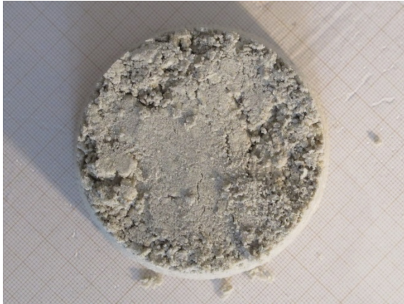
E/C = 0.5 ; Le mélange est très sableux, il ne s'écoule pas du tout ; présence de grumeau de ciment (semblable à E/C = 0,4 )
