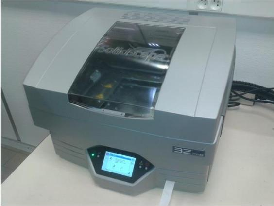
Imprimante 3D pour la réalisation de pièces-modèles en cire, servant à obtenir ensuite des pièces métalliques par micro-fonderie par le procédé « fonderie en cire perdue ».
