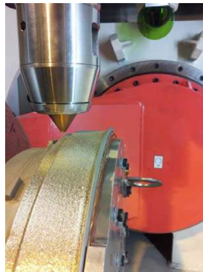
Rechargement d'une virole par procédé CLAD
