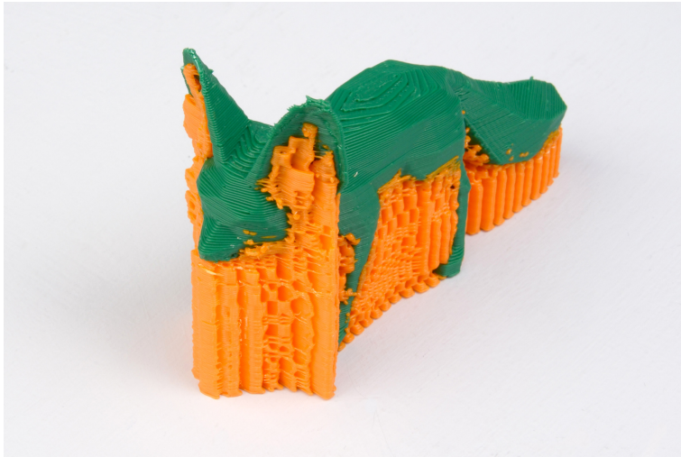
FIGURE 4.5 : Un exemple d'un objet imprimé avec un support.
