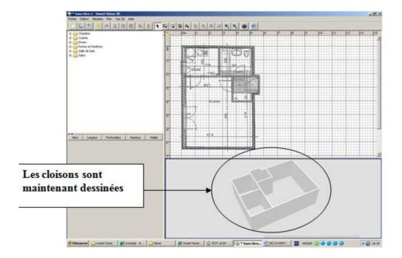
Changez l'épaisseur et la matière des murs extérieurs Les murs extérieurs mesurent 30 cm de large et sont en briques rouges.
