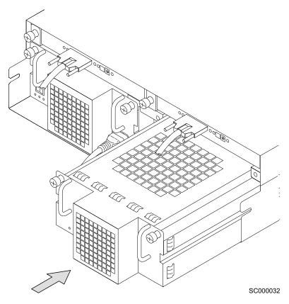
Figure 64. Inserting a fan assembly
