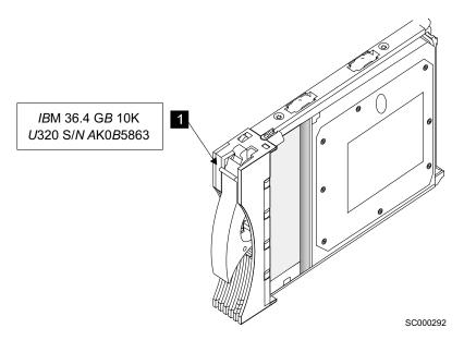
Figure 32. Disk drive module label (2104 Model DS4 or Model TS4)
