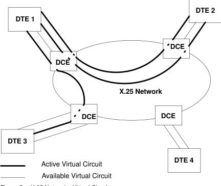
Figure 5. X.25 Network : Virtual Circuits
