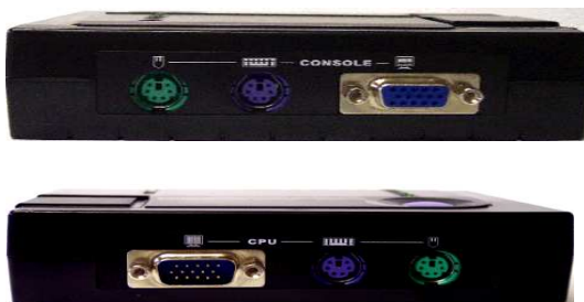
Figure 16. Unité d'extension KVM (locale et distante) 300 m maximum.
