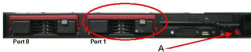
Figure 54. Retrait du disque de droite
