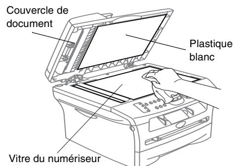
Dans l'ADF, nettoyez la barre de plastique blanc et la vitre du numériseur sous la barre blanche à l'aide d'un chiffon doux, non pelucheux et humecté d'alcool isopropylique.
