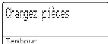
L'appareil utilise un tambour pour créer des images imprimées sur papier. Lorsque le message **Changez pièces Tambour** s'affiche sur l'écran LCD, cela signifie que le tambour arrive en fin de vie et qu'il est temps d'en acheter un nouveau.
