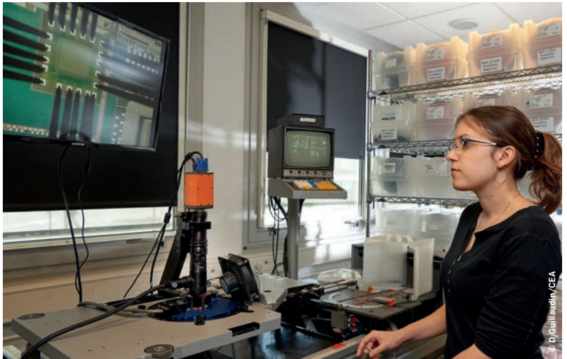
↑ Tests de MRAM : mesure de la résistance, du TMR (Tunneling Magnetic Resist), du retournement et de la dispersion de ces valeurs sur le wafer complet.
