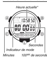
Le mode Chronomètre vous permet de mesurer le temps écoulé, des partielles et deux arrivées. La portée de la montre est de 23 heures, 59 minutes, 59,99 secondes. La mode Chronomètre offre en outre une fonction d'auto-démarrage.
