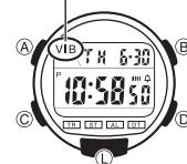
En mode Indication de l'heure, appuyez environ deux secondes sur (D) pour mettre le vibreur en service (Indicateur de vibreur en service affiché) ou hors service (Pas d'indicateur).
