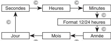
3. Quand les chiffres des secondes sont sélectionnés (ils clignotent), appuyez sur **(D)** pour remettre les secondes à 00. Si vous appuyez sur **(D)** quand les secondes sont entre 30 et 59, les secondes reviennent à 00 et les minutes augmentent d'une unité. Si les secondes sont entre 00 et 29, les minutes ne changent pas.
