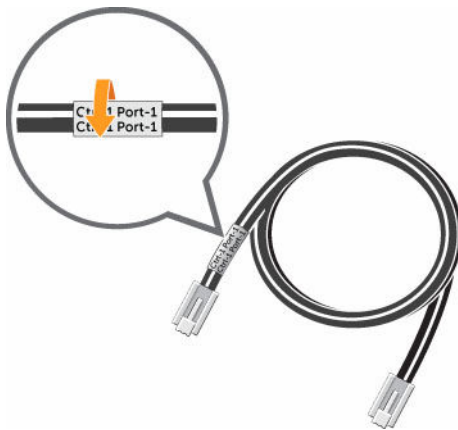
Figure 33. Enroulez l'étiquette autour du câble
