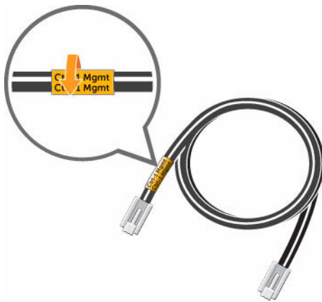
Figure 36. Enroulez l'étiquette autour du câble
