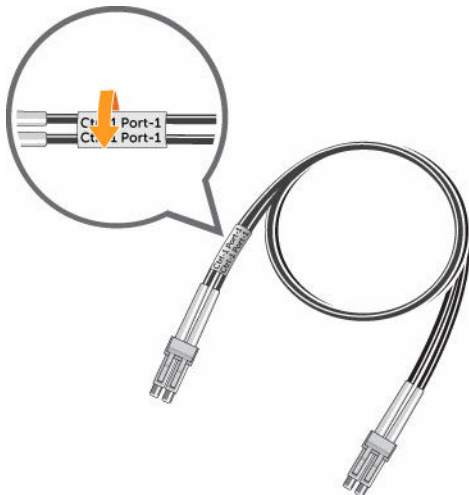
Figure 24. Enroulez l'étiquette autour du câble
