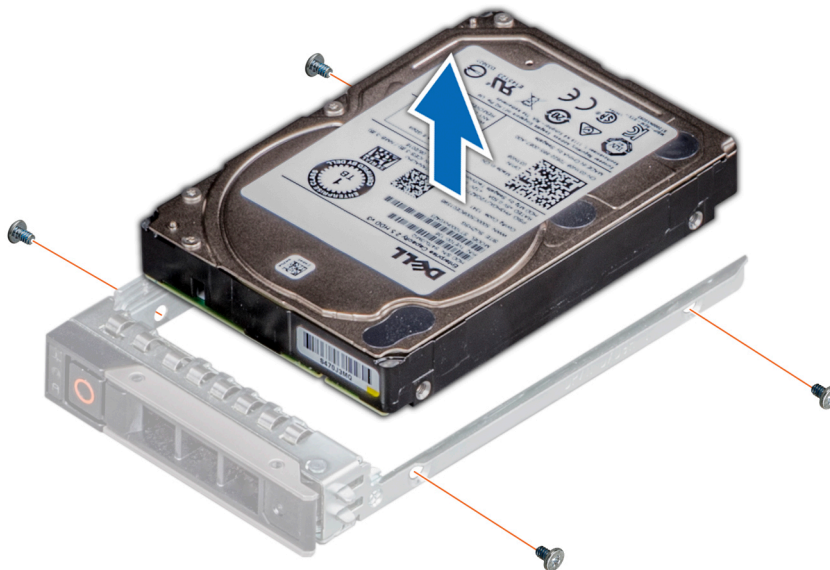
Figure 57. Retrait du disque dur de son support
