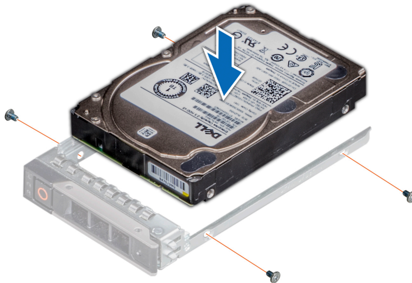
Figure 33. Installation d'un disque dans le support de disque
