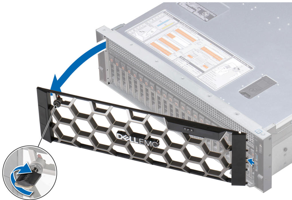
Figure 13. Retrait du cadre avant en option avec l'écran LCD
