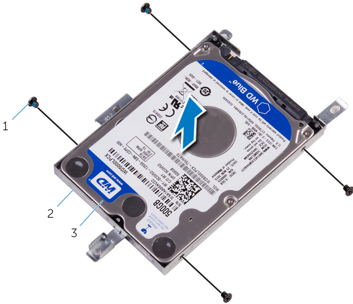
Figure 8. Retrait des vis du disque dur
