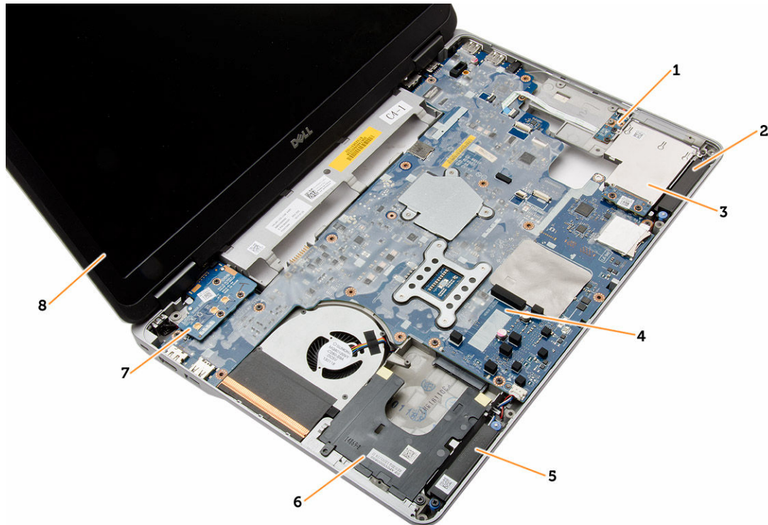
Figure 2. Vue de dessus - Clavier et ensemble repose-mains retirés
