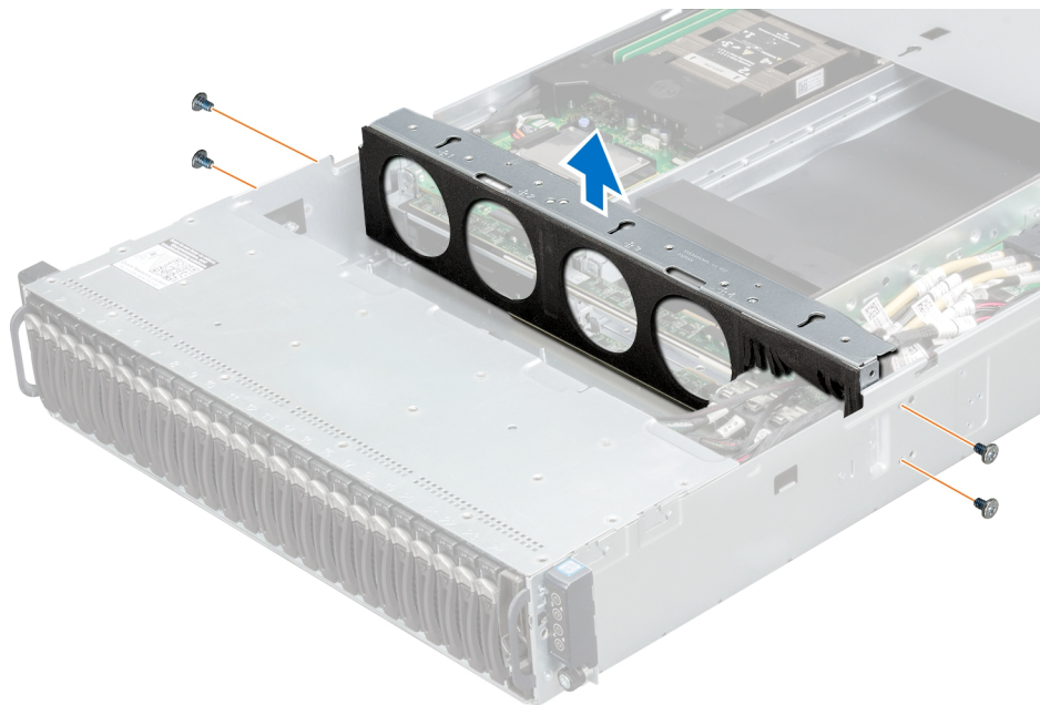
Figure 103. Retrait du mur médian
