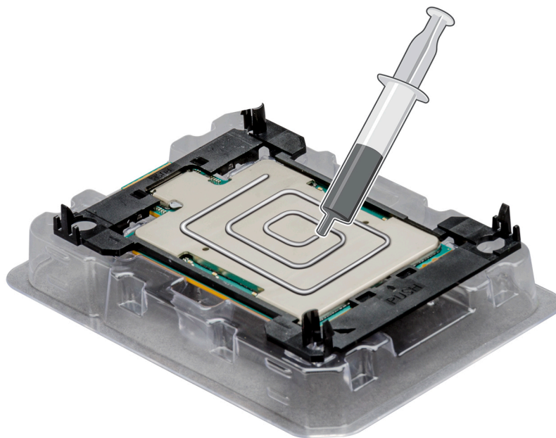
Figure 34. Application de graisse thermique sur la partie supérieure du processeur
