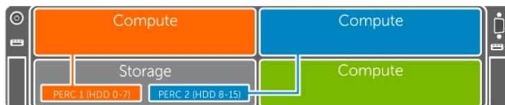
Figure 12. Configuration de double hôte fractionné : châssis à quatre baies
