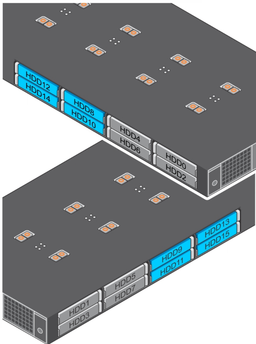
Figure 15. Mappage des lecteurs aux deux contrôleurs de stockage
