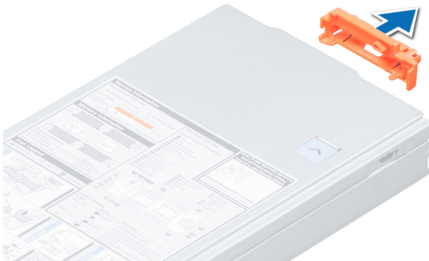
Figure 9. Retrait du cache de connecteur d'E/S.
