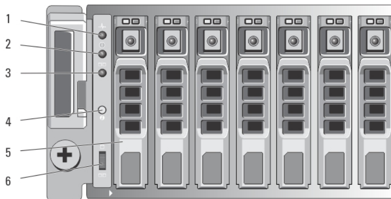
Figure 2. Voyants et fonctions du panneau avant : PowerVault MD3820f
