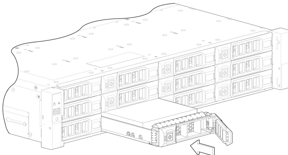
Figure 46. Installation d'un module de support de disque LFF (1 sur 2)
