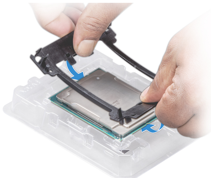
Figure 14. Installation du support de processeur
