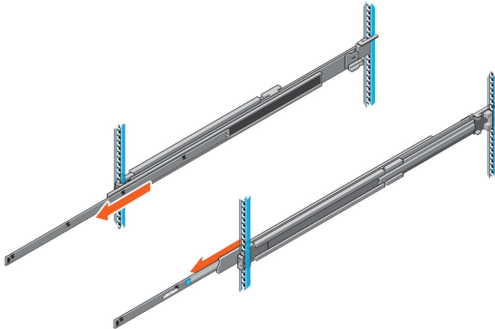
Figure 25. Dégagement du rail interne
