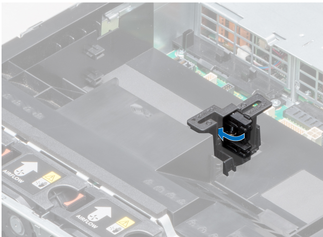
Figure 61. Fermeture du loquet du support de carte PCIe
