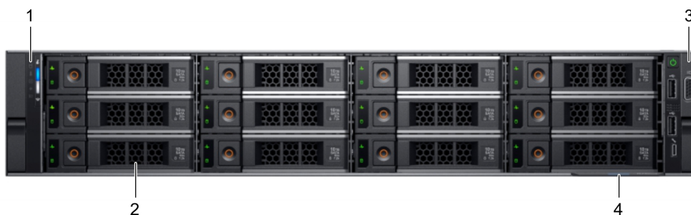
Figure 2. Vue avant du système de disques 12 x 3,5 pouces
