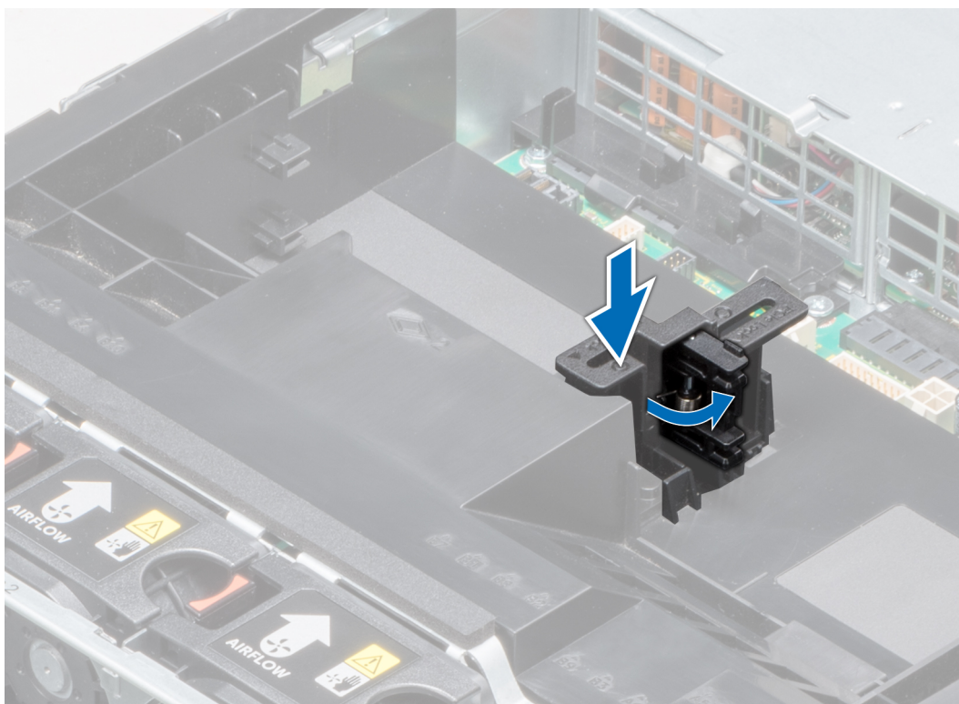
Figure 60. Ouverture du loquet du support de carte PCIe
