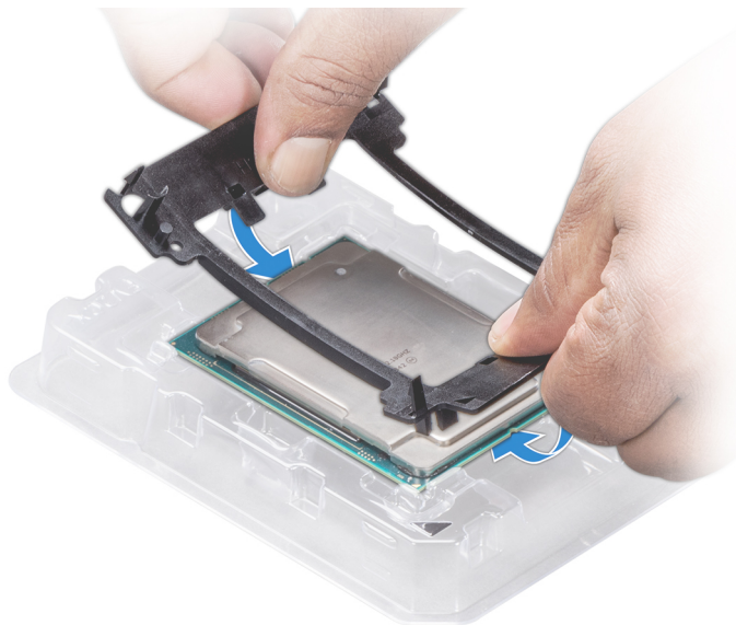
Figure 55. Installation du support de processeur
