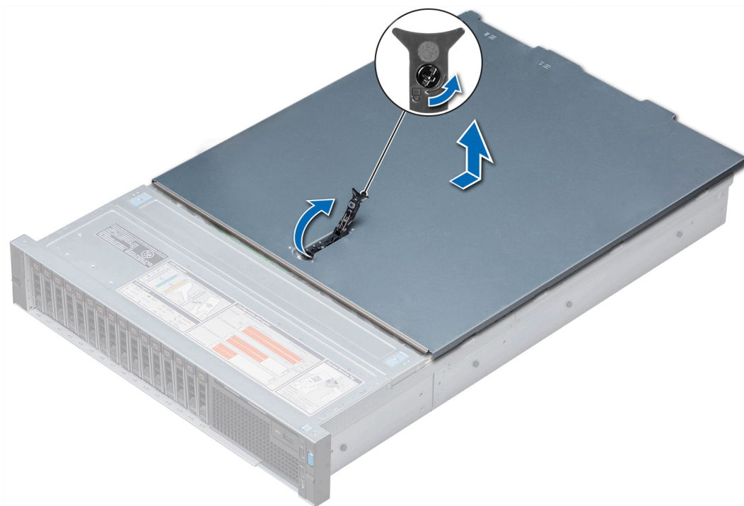
Figure 16. Retrait du capot du système
