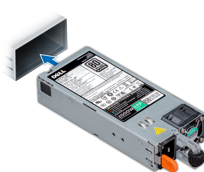
Figure 101. Installation d'une unité d'alimentation
