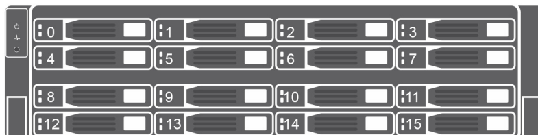
Figure 4. Numérotation des lecteurs du Système de stockage SCv3000
