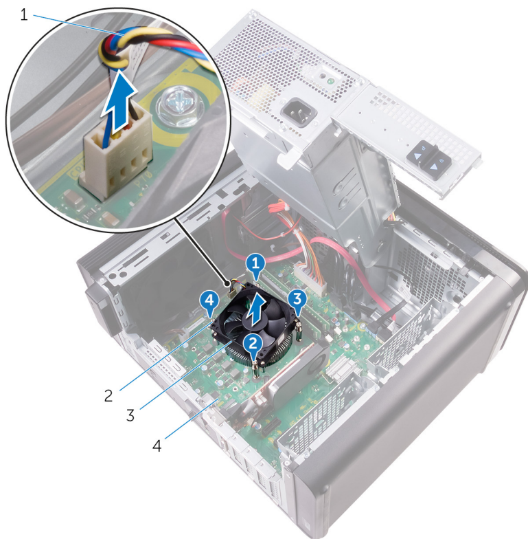
Figure 34. Retrait du ventilateur du processeur et du dissipateur de chaleur
