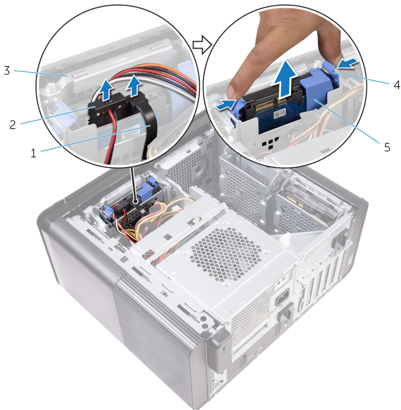
Figure 7. Retrait de l'assemblage du disque dur
