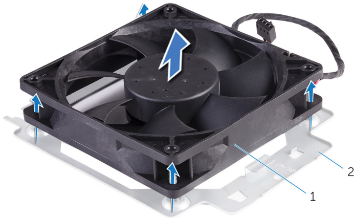
Figure 19. Retrait du ventilateur du châssis
