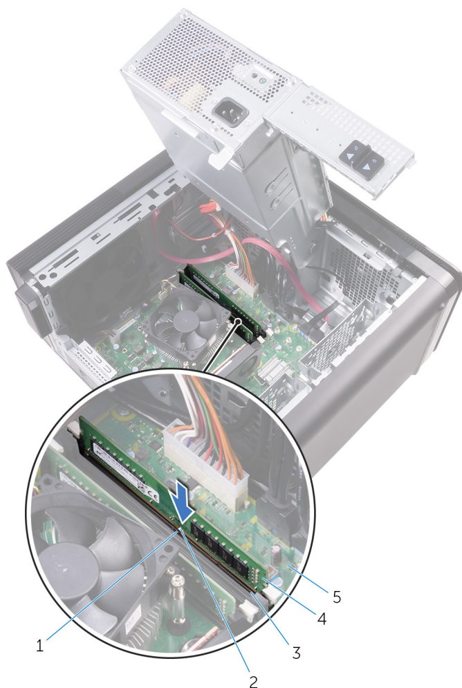
Figure 24. Remise en place du module de mémoire
