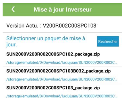
Figure 4-67 Mise à niveau de l'onduleur
