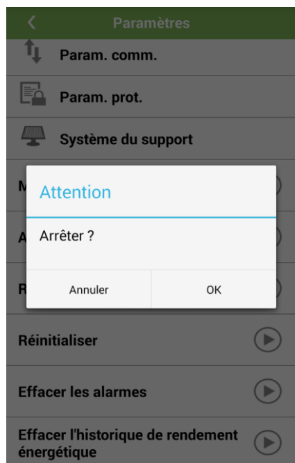
Figure 4-44 Confirmation de l'arrêt de l'onduleur
