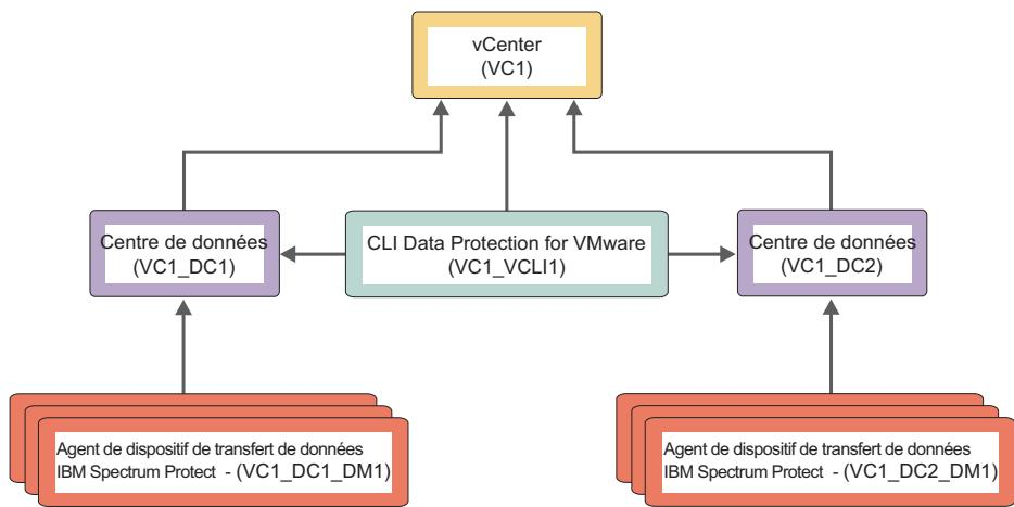
*Figure 3. Relations de proxy entre les noeuds dans un environnement vSphere utilisant deux centres de données VMware. Les flèches pointent du noeud d'agent proxy vers le noeud de cible proxy.*
