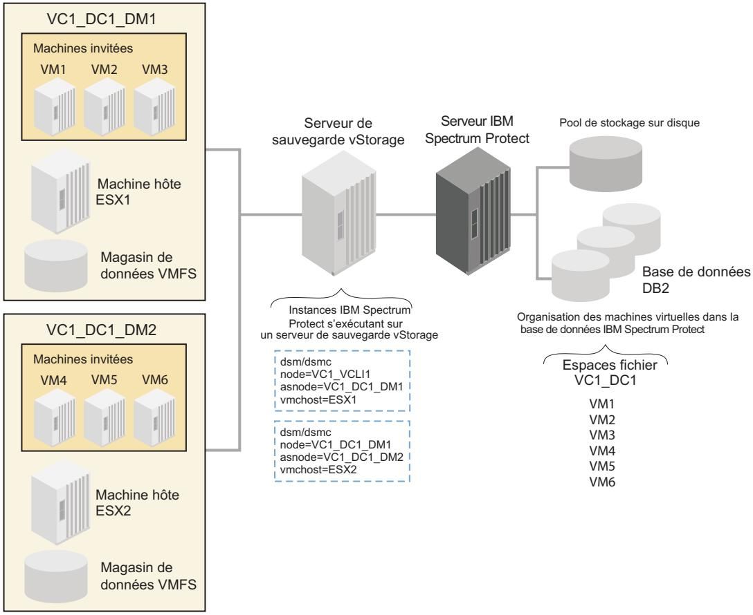
Figure 2. Relations entre les noeuds et applications dans un environnement vSphere contenant un centre de données VMware et deux noeuds de transfert de données.
