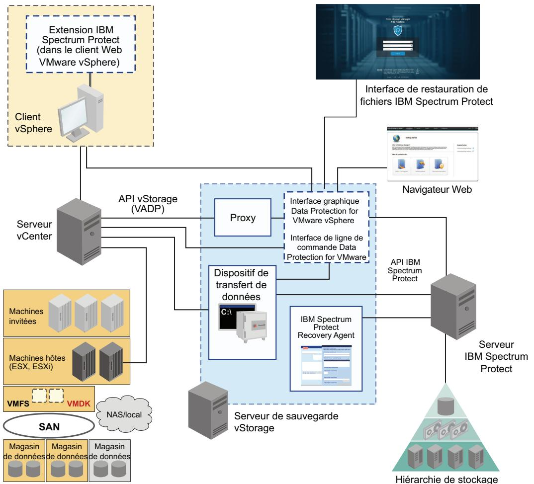
Figure 1. Composants d'un système IBM Spectrum Protect for Virtual Environments dans un environnement utilisateur VMware vSphere
