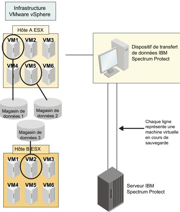
Figure 4. Machines virtuelles utilisant des magasins de données uniques
