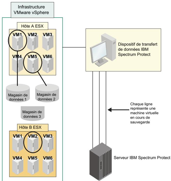
*Figure 5. Machines virtuelles utilisant des magasins de données uniques, avec une valeur différente pour l'option `vmlimitperhost`*
