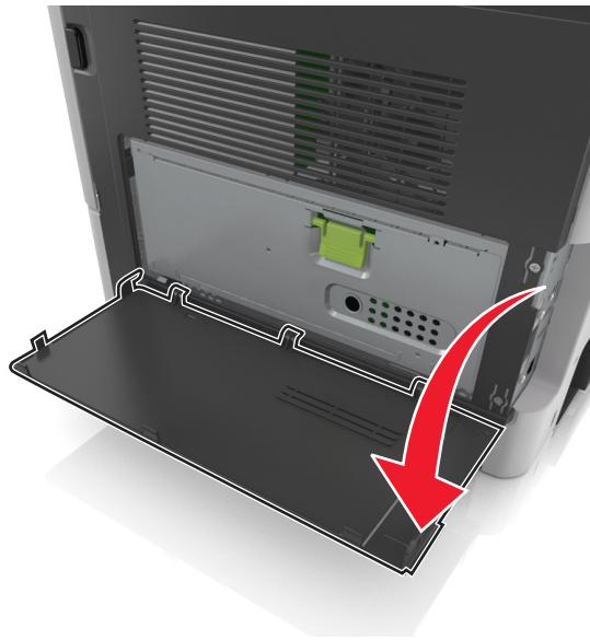
**2** 轻轻按通道盖门右边的制动片，然后滑动通道盖门以移除它。
