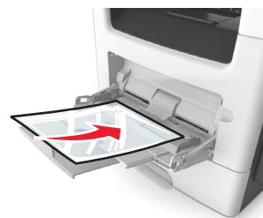
**注意：**当加载 A6 尺寸的纸张时，请确认多功能进纸器扩展板轻轻地靠着纸张的边缘，以使最后几张纸留在原位。
