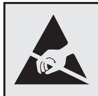
此符号表示对静电敏感的部件。请先接触打印机的金属外框，再接触这些符号附近的区域。
