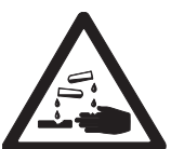
Risque de corrosion
