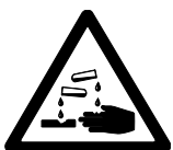
Risque de corrosion
