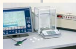
Module de poste de test avec station de pesage, testeur de comprimés et mesure des dimensions
