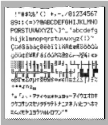
Der GA42 besitzt einen Selbst-Test, der automatisch den Zeichensatz des Druckers ausdruckt.
