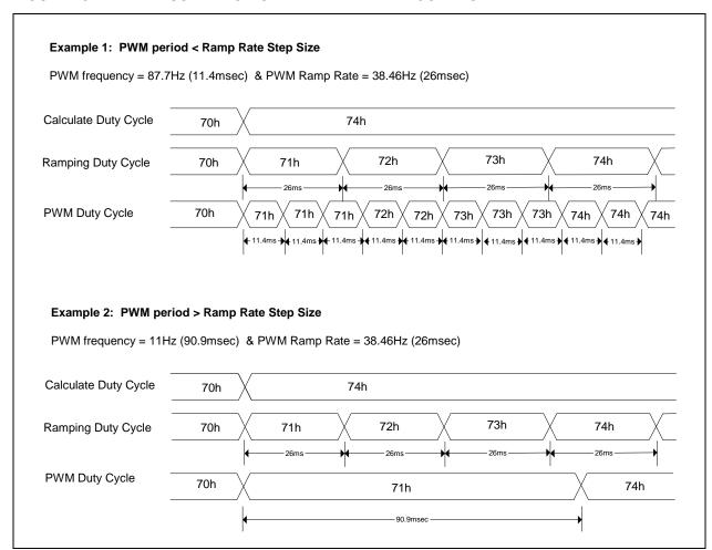
FIGURE 20-7: ILLUSTRATION OF PWM RAMP RATE CONTROL
