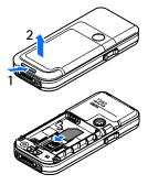
Insérez la batterie (4). Vérifiez le bon positionnement des connecteurs de la batterie. Utilisez toujours des batteries Nokia d'origine. Voir Directives d'authentification des batteries Nokia p. 129.
