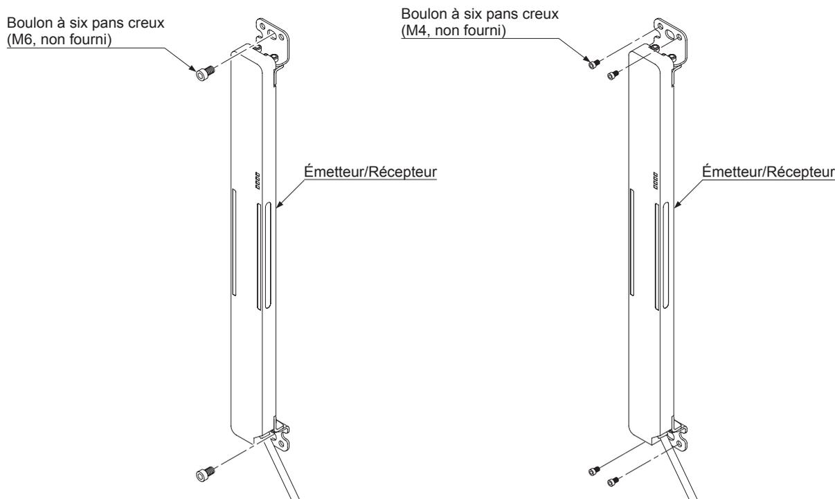
Notes : Les modèles **SF2C-H28** et **SF2C-H32** nécessitent l'utilisation de l'étrier de support intermédiaire multifonctions **MS-SFC-4** (en option). Consultez la section <En cas de montage avec étriers de support intermédiaire multifonctions **MS-SFC-4** (en option)> pour plus d'informations sur le montage.
