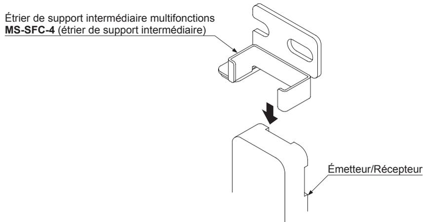
Étape 2. Fixez l'étrier de support intermédiaire multifonctions sur la surface de montage soit avec un boulon à tête hexagonale (M6, non fourni) soit avec un boulon à six pans creux (M4, non fourni).
