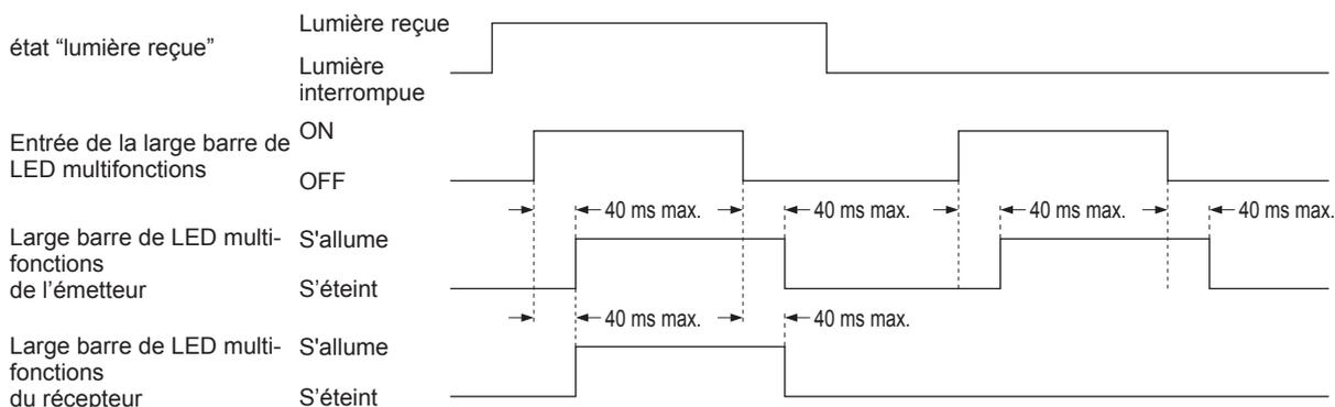
Note: Lorsque la lumière de l'émetteur est reçue par le récepteur, la large barre de LED multifonctions du récepteur s'activera.
