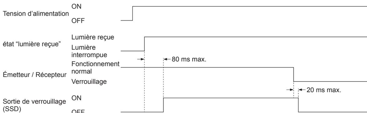
Note: Si la lumière de l'émetteur est reçue par le récepteur lorsque l'émetteur est verrouillé, l'information de verrouillage est communiquée au récepteur et la sortie de verrouillage (SSD) est désactivée (OFF).
