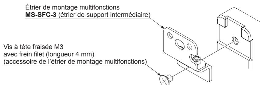
Étape 3. Fixez l'étrier de montage multifonctions sur la surface de montage soit avec deux boulons à six pans creux (M6, non fournis) soit avec quatre boulons à six pans creux (M4, non fournis).
