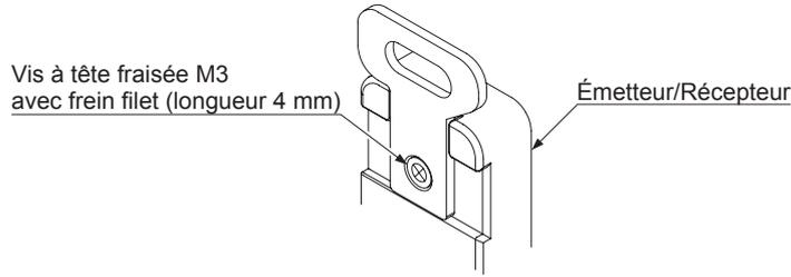
Étape 2. Resserrez la vis à tête fraisée M3 (avec frein filet, longueur 4 mm). Le couple de serrage doit être de 0,3 Nm max.
