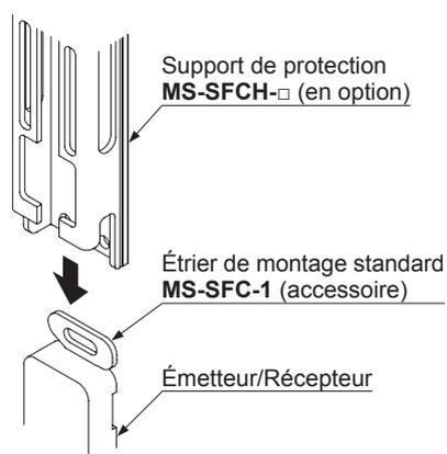
Étape 2. Alignez les trous de fixation du support métallique de protection et de l'étrier de montage standard. Fixez l'ensemble sur la surface de montage à l'aide de deux boulons à six pans creux (M5, non fournis)
