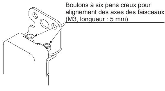
Étape 4. Changez le sens de la pièce A de l'étrier de montage multifonctions. Serrez les deux boulons à six pans creux pour alignement des axes des faisceaux M3 (longueur 5 mm). Le couple de serrage doit être de 2 Nm max.
