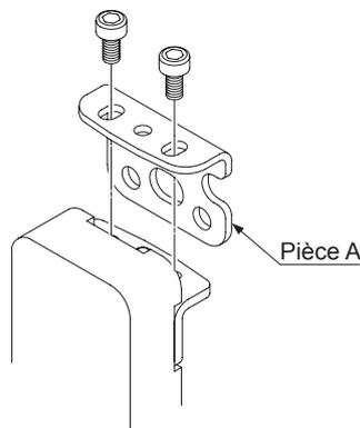
Étape 5. Fixez l'étrier de montage multifonctions sur la surface de montage soit avec deux boulons à tête hexagonale (M6, non fournis) soit avec quatre boulons à tête hexagonale (M4, non fournis).
