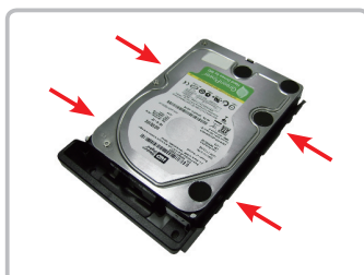
Trinn 3. Installer en harddisk på diskskuffen og lås den med fire skruer.
