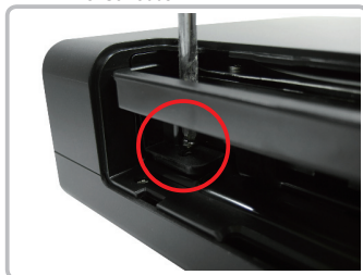
Schritt 5. Fixieren Sie die Festplattenschublade durch Anziehen der Schrauben.
