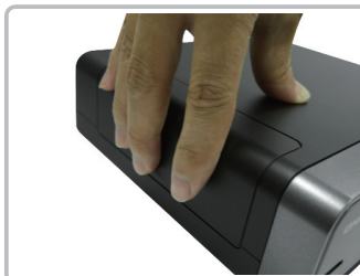
Steg 6. Stäng luckan. Ett klickljud hörs är locket är stängt korrekt.
