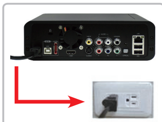
Stap 7. Sluit de mediaspeler op de netvoeding aan.
