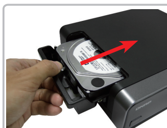
Trin 4. Isæt diskbakken til medieafspilleren.
