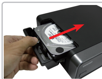
手順4. ディスクトレイをメディアプレーヤーに挿入します。
