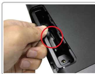
Шаг 2. Поднимите лоток диска и аккуратно и звлеките его.
