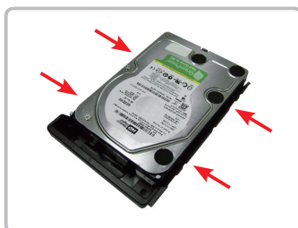
Czynność 3. Zainstaluj dysk twardy na tacy dysku i zamocuj czterema śrubami.
