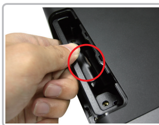
Passo 2. Levante a bandeja de disco e puxe-a gentilmente.
