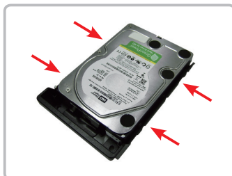
步驟三：把硬碟安裝於硬碟架上並用四顆螺絲鎖住固定。
