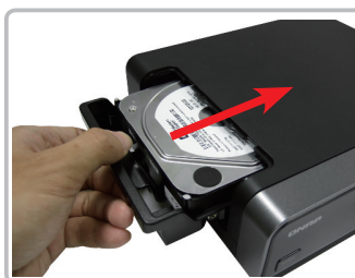
Czynność 4. Włóż tacę dysku do odtwarzacza multimedialnego.
