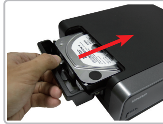
Adım 4. Disk tepsisini ortam oynatıcısına takın.
