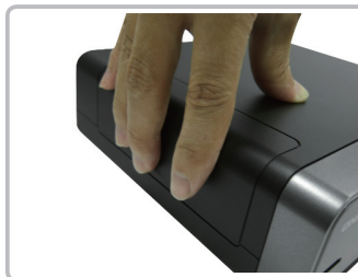
步骤六：盖上侧边的盖子，如果安装正确会听到卡一声。
