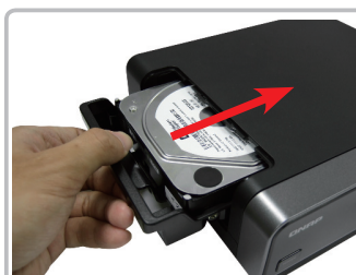
Fase 4. Inserire il vassoio del disco nel lettore multimediale.
