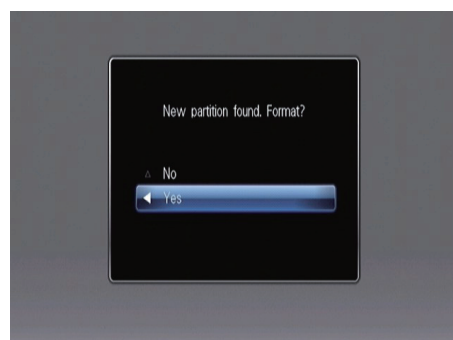
Fase 4. Seguire le istruzioni presentate sullo schermo per formattare il sistema. Se il disco rigido dell'NMP-1000 è già stato formattato come file system NTFS, FAT32 o EXT3, questa fase verrà saltata.
