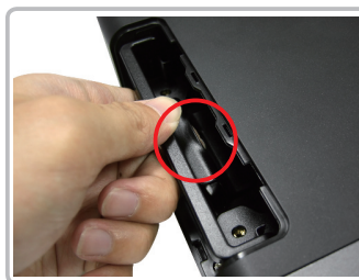
Trin 2. Løft diskbakken og træk den forsigtigt ud.
