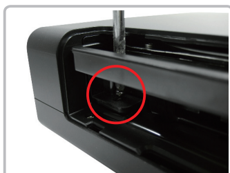
Vaihe 5. Lukitse levykelkka kiinnittämällä ruuvi.
