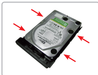
手順3. ディスクトレイにハードドライブをインストールし、4本のねじで固定します。
