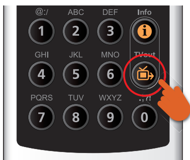
Fase 3. Selezionare l'ingresso corretto per il segnale nella TV. (Verificare che l'ingresso TV corrisponda all'ingresso video e audio a cui è stato collegato l'NMP-1000 sul proprio amplificatore.)*
