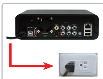
Vaihe 7. Kytke mediasoitin virtalähteeseen.
