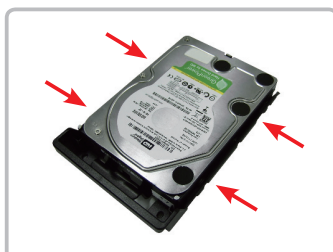
Stap 3. Leg een harde schijf op de lade en zet hem met vier schroeven vast.
