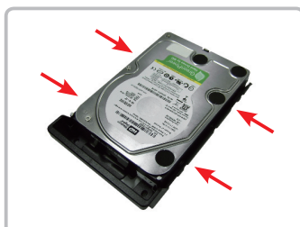
Trin 3. Installer et harddiskdrev på diskbakken og lås den med fire skruer.
