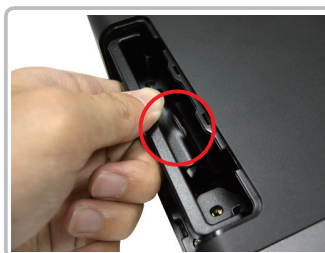
Schritt 2. Heben Sie die Festplattenschublade an, ziehen Sie sie sanft heraus.
