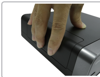
Czynność 6. Załóż pokrywę. Prawidłowe zamknięcie pokrywy sygnalizowane jest kliknięciem.
