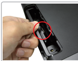
Paso 2. Levante la bandeja del disco y tire de ella cuidadosamente.
