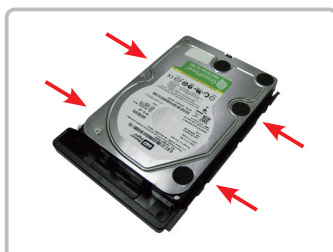
Etape 3. Installez un disque dur sur le plateau de disque et attachez-le avec quatre vis.
