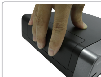
Шаг 6. Закройте крышку. Если она закрыта п равильно, раздается щелчок.
