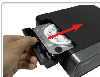
Paso 4. Inserte la bandeja del disco en el reproductor multimedia.
