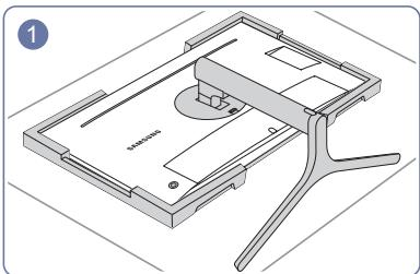
Положите на пол защитный пенопластовый материал (стирофон), входящий в комплект, и разместите на нем устройство экраном книзу, как показано на рисунке.
