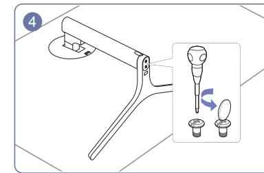
Открутите соединительный винт в нижней части подставки.
