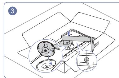
Установите шейку подставки дисплея на устройству в соответствии с положением зажимов.
