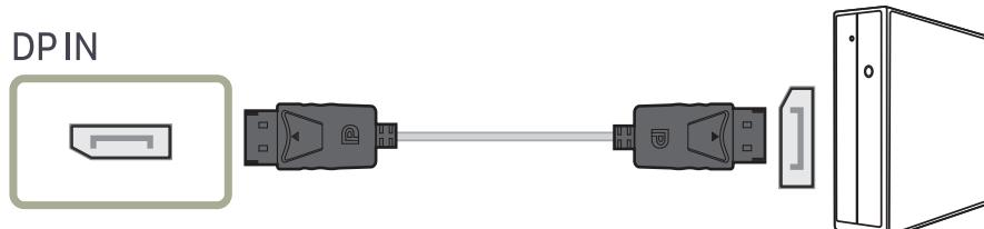
— Рекомендуется использовать кабель DP длиной до 1,5 м. Использование более длинного кабеля может повлиять на качество изображения.
