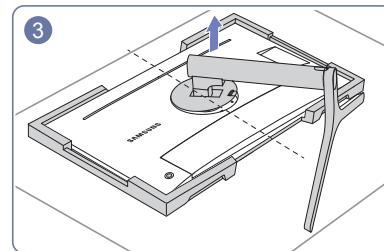
Повернув шейку подставки дисплея на 10°, приподнимите шейку подставки для ее демонтажа с устройства.
