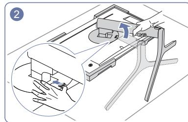
Толкните ключ вверх и удерживайте. Поверните шейку подставки дисплея против часовой стрелки на 10°.
