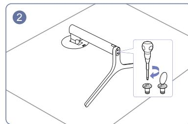
Проверьте, надежно ли закреплен соединительный элемент подставки. Полностью закрутите соединительный винт в нижней части подставки, чтобы как следует зафиксировать соединительный элемент.
