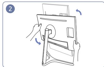
Поверните устройство в самое высокое вертикальное положение.
