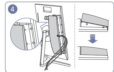
Расположите кабели, проведя их через паз на ЗАДНЕЙ КРЫШКЕ, а затем прикрепите КРЫШКУ ЗАДНЕЙ ПАНЕЛИ. При установке КРЫШКИ ЗАДНЕЙ ПАНЕЛИ, сначала поверните шесть ребер КРЫШКИ ЗАДНЕЙ КРЫШКИ.
