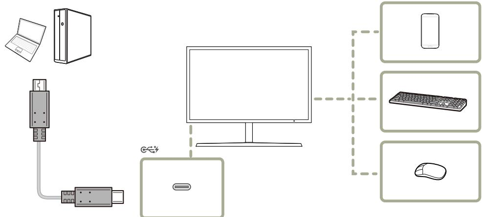
Если к компьютеру подключено несколько устройств — источников сигнала, то множество кабелей вокруг ПК может создавать беспорядок. Подключение устройств непосредственно к изделию позволяет решить эту проблему.
