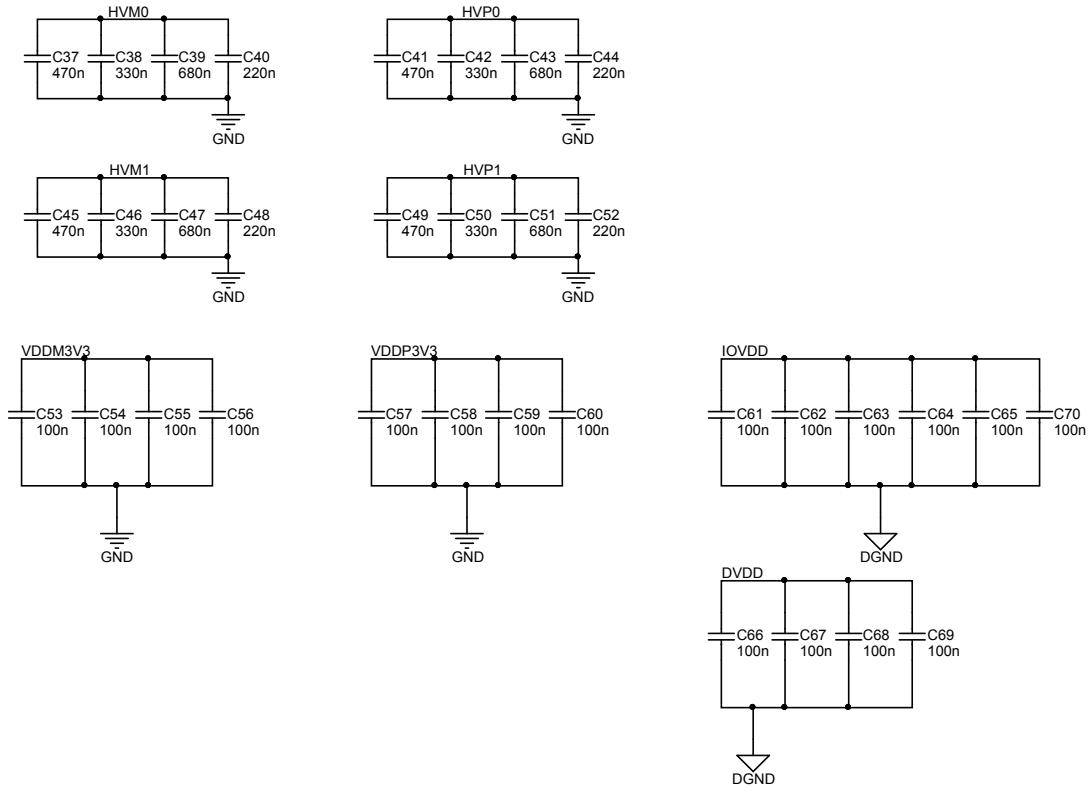
**Figure 18. STEVAL-IME014V1D schematic**
