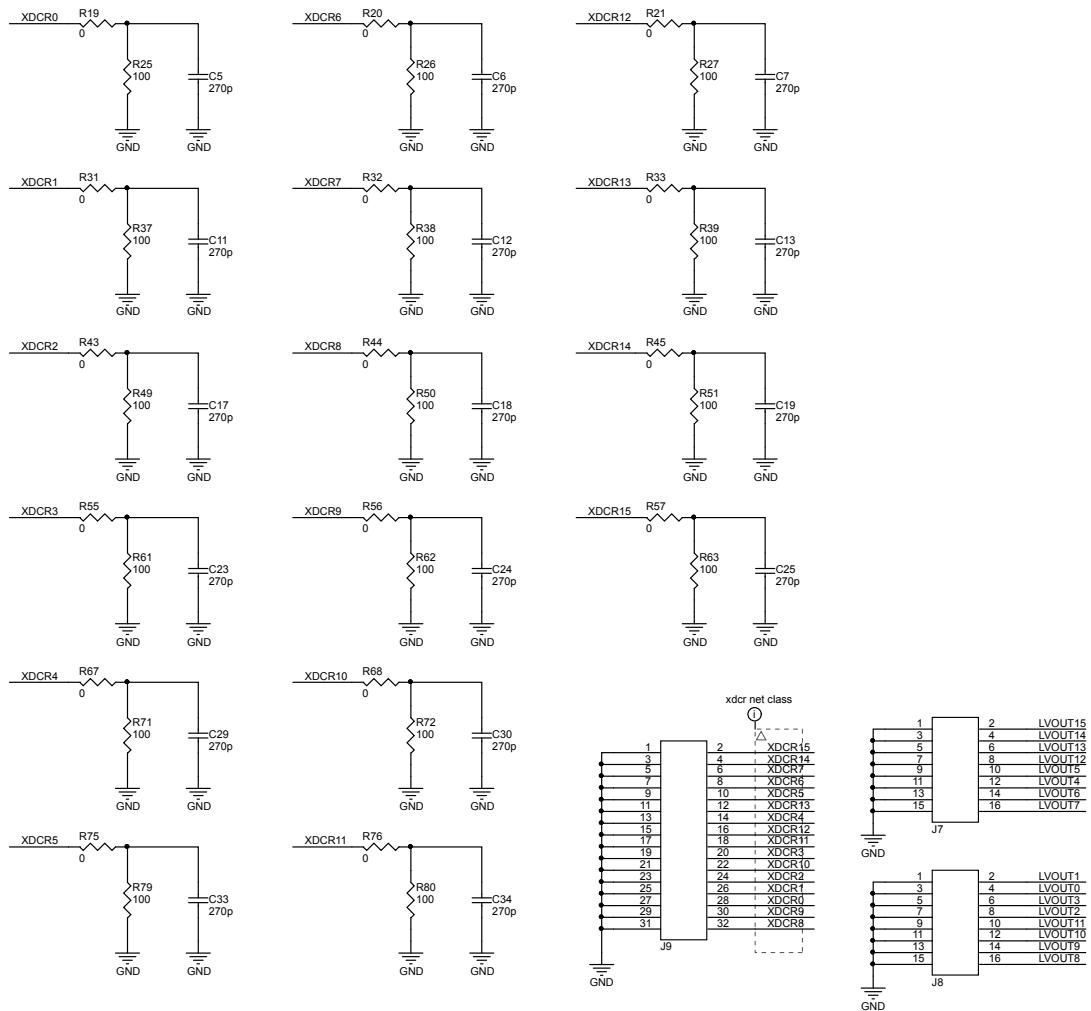
**Figure 17. STEVAL-IME014V1 schematic 4**
