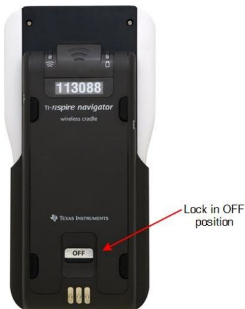
2. Per collegare il palmare, con lo schermo rivolto verso l'alto infilare il palmare nella parte superiore della basetta wireless . Accertarsi che entrambi i lati del palmare siano inseriti in entrambe le guide laterali.
