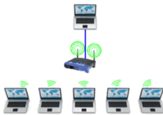
Lærer har kabelforbindelse og elever har trådløs forbindelse
