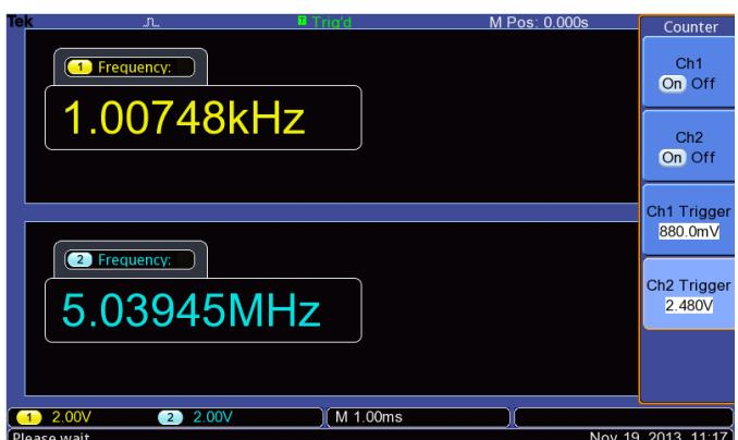
Des fréquencemètres 2 voies affichant 6 chiffres sont fournis en standard sur tous les modèles TBS1000.
