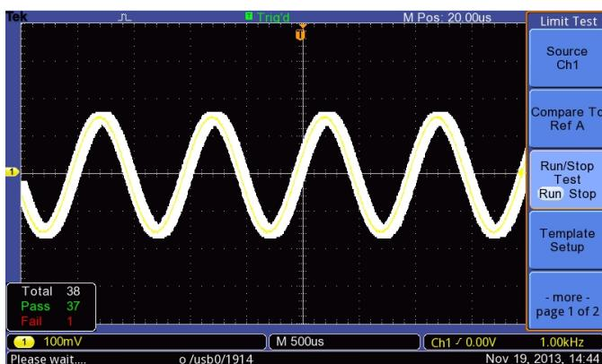
Le test des valeurs limites retourne un résultat de type réussite/échec en comparant rapidement le signal d'entrée déclenché avec un modèle défini par l'utilisateur.
